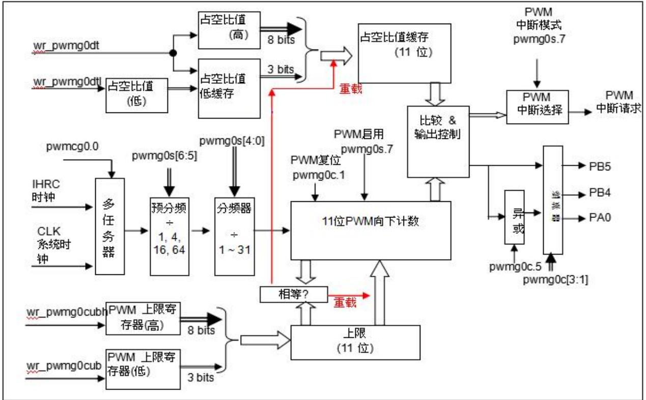
图 13: 11 位 PWM 生成器硬件框图
