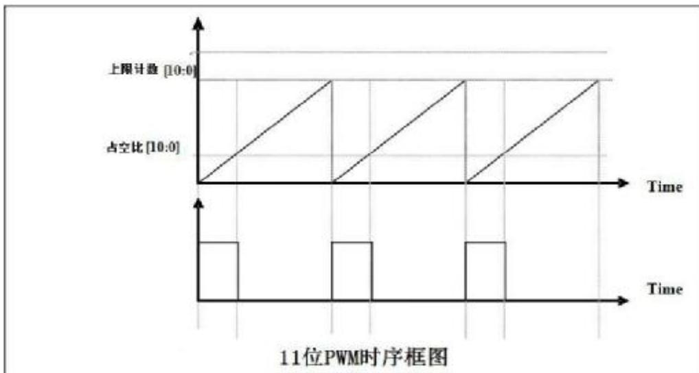
图 14: 11 位 PWM 生成器输出时序图
