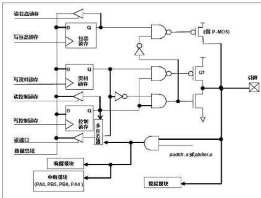
图 19: IO 引脚缓冲区硬件图
