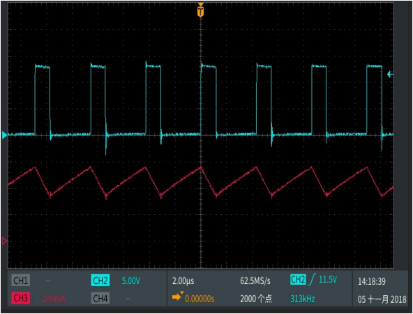
SW 脚与电感电流工作波形
